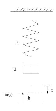
Der abgebildete Schwinger soll eine variable Masse m=m(t) haben. Die Masse besteht aus einem Gefäß, das mit Wasser gefüllt ist. Dieses Wasser läuft während des Schwingungsvorgangs aus. Die Masse setzt sich zusammen aus der Masse des leeren Gefäßes  $m_0$  und der variablen Wassermasse  $m_w(t)$ :
